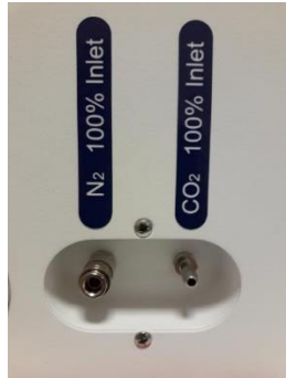
Figura 11.1 Entradas de gases en la parte posterior de las incubadoras multicámara FIV Mini MIRI® Dry y Mini MIRI® Humidity
