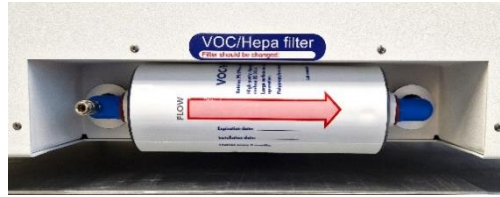
Figura 12.3 Filtro COV/HEPA correctamente instalado
