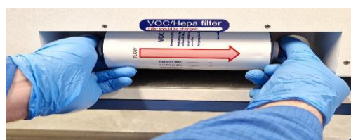
Figura 12.2 Procedimiento de inserción y extracción del filtro COV/HEPA
